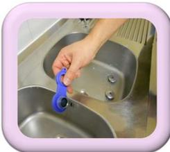
Nous avons parlé ensuite des mousseurs autorégulés, et fait une démonstration sur un robinet de la résidence. Après une première mesure avec le débitmètre et le constat d'un débit de 13 litres/minute, nous avons utilisé l'eau du test pour arroser les plantes. Après changement du mousseur et la réalisation d'une nouvelle mesure, les résidents ont constaté un débit d'environ 6 litres.
